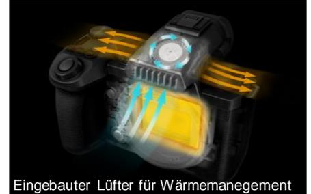
Eingebauter Lüfter für Wärmemanagement
